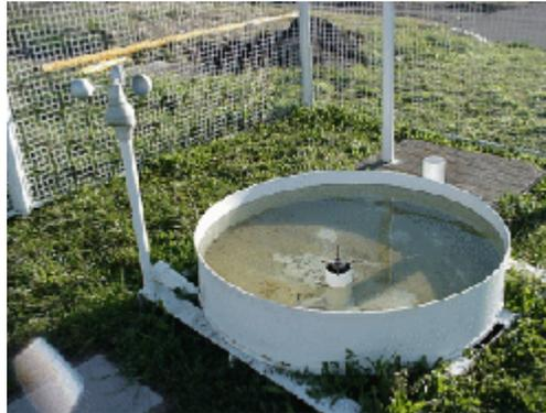
Fig. 1.4: Tanque de Evaporación
