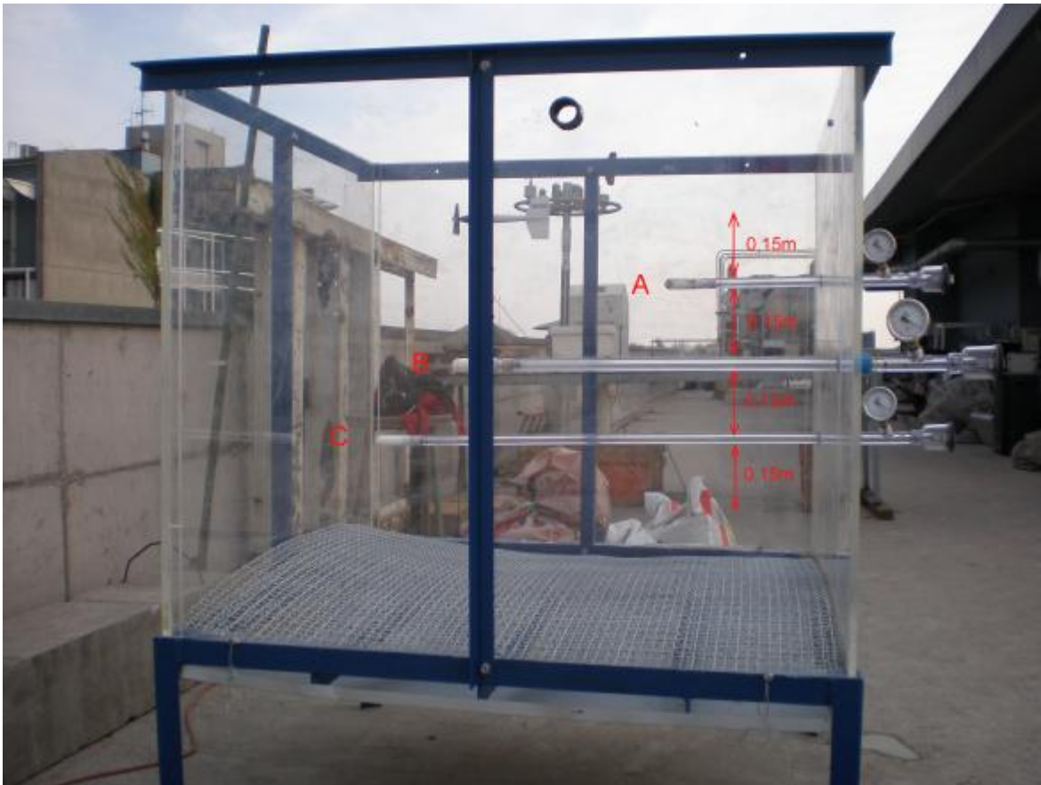
Figura 2.4: Ubicación de los Tensiómetros
